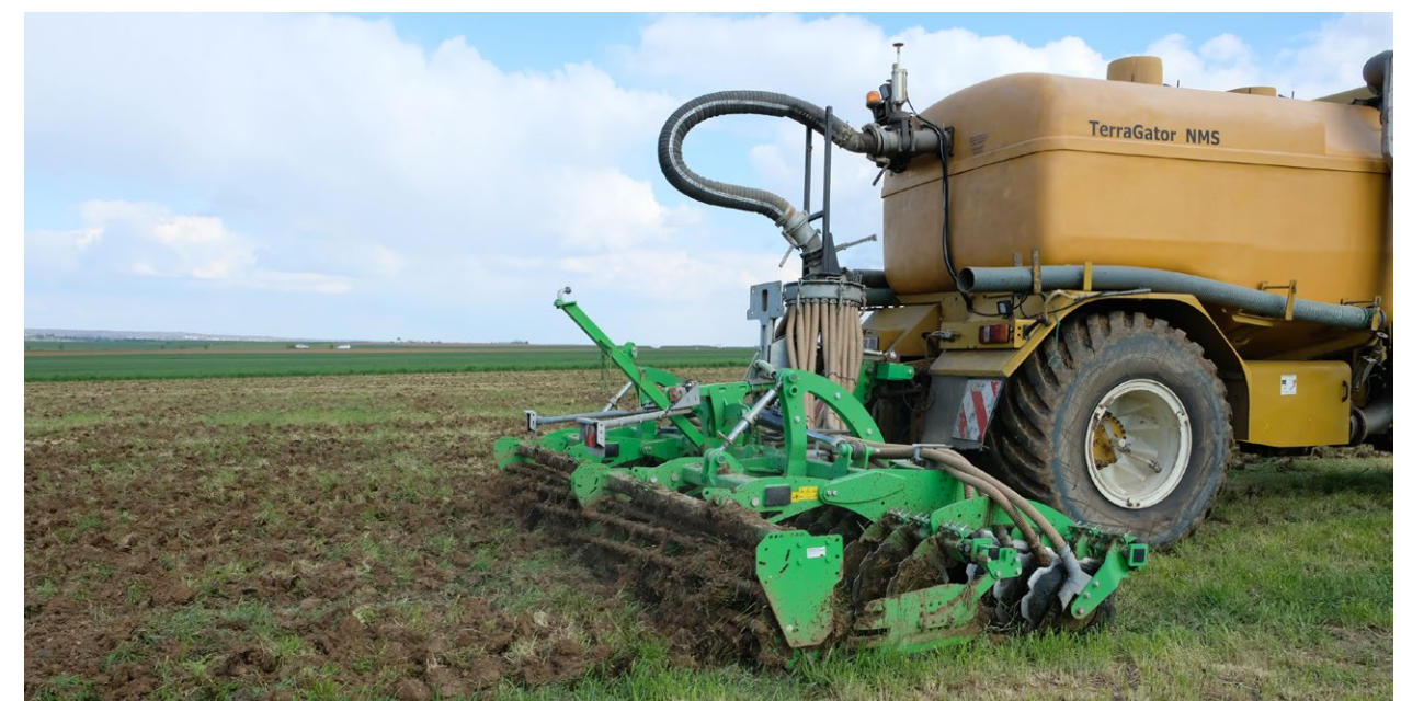
Épandage de lisier avec automoteur et enfouisseur à disques
