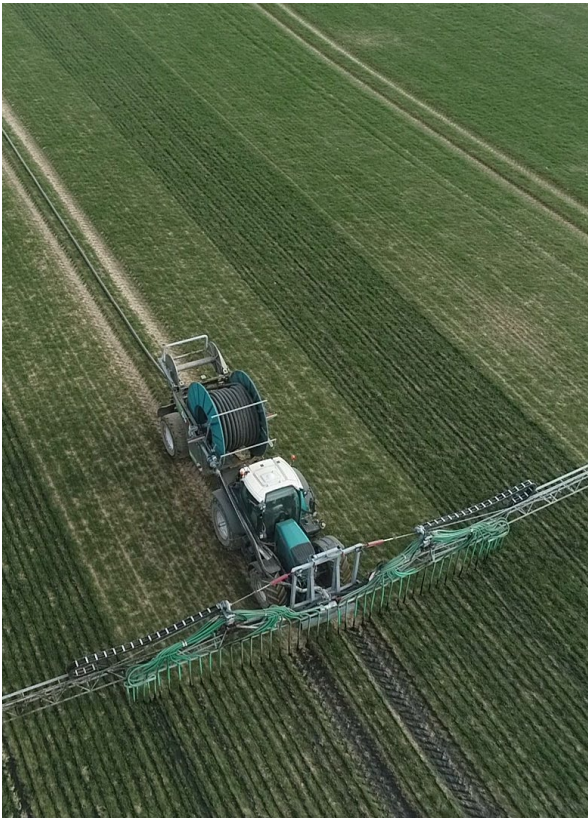
Épandage de digestat liquide sans tonne avec système Duaferti ®
